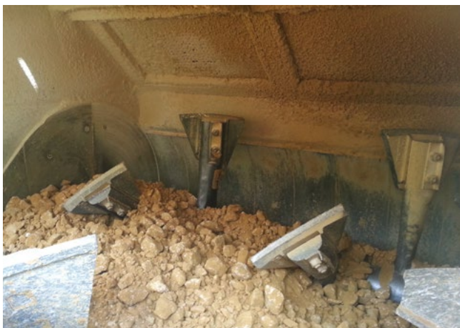
Matériaux malaxés avec de la chaux vive
