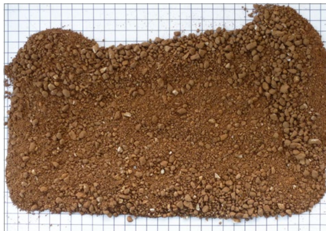
Matériaux argileux criblés < 5 mm avec chaux vive
